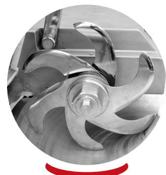
Tête avec 6 couteaux Head with 6 knives
